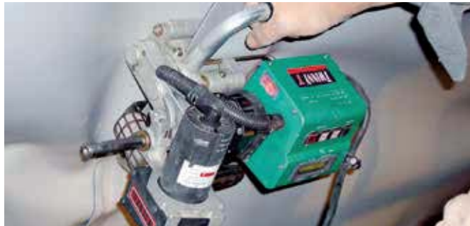
TWINNY T met praktische dwarsgreep om in een tunnel boven uw hoofd te kunnen lassen.
