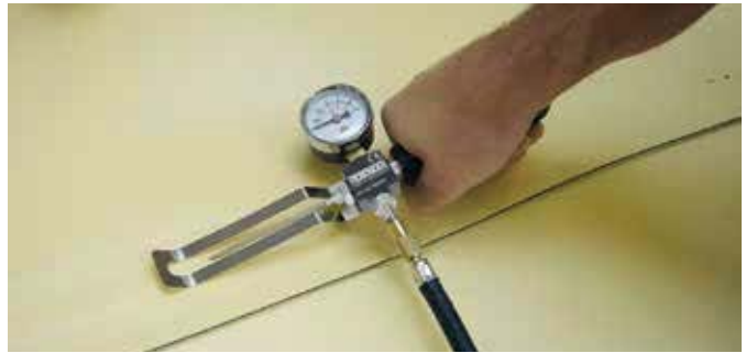
Testen van de dichtheid van overlapsnaden met testkanaal.
