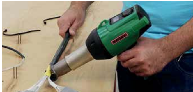
Krimpen bij het confectioneren van kabels – ideaal met de GHIBLI AW
