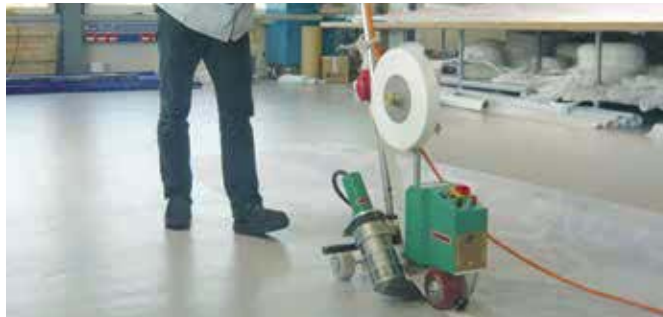
Oplassen van spanbanden met de hoogst mogelijke snelheid.
