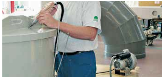
ROBUST-blazer als luchtvoorziening voor de WELDING PEN.
