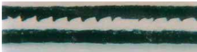
Gelast met behulp van gripmondstuk voor een 25% sterkere lasnaad. Hoofdzakelijk voor TPO geomembranen.
