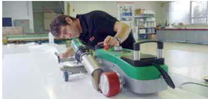
Eenvoudig lassen van zomen en keder met behulp van zoom-/kederpakket.
