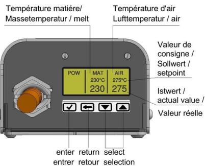
Die Temperatur der Schweißmasse muss die vor-eingestellte **Anlaufschutz-Temperatur** überschritten haben, dann läuft ein Timer ab. Nach Ablauf der Aufheizzeit gibt die Schutzschaltung den Antrieb frei.
