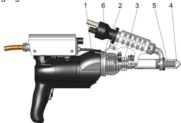
Typ **MAK** ist ein Handextruder mit Eigenluftversorgung (Autoair).
