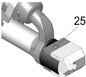
Es ist darauf zu achten, dass die Vorwärmdüse über die gesamte Nahtbreite eine intensive und gleichmäßige Vorwärmung (Aufschmelzung) des Grundmaterials – bei möglichst geringer Warmlufttemperatur – gewährleistet. Für größere Nahtbreiten ist eine breitere Vorwärmdüse als Zubehör erhältlich.
